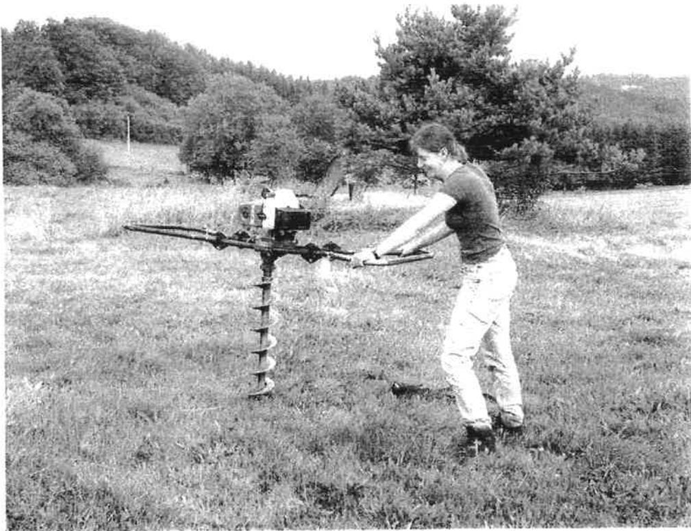
Réalisation de trous à la tarière à moteur pour les essais de perméabilité
